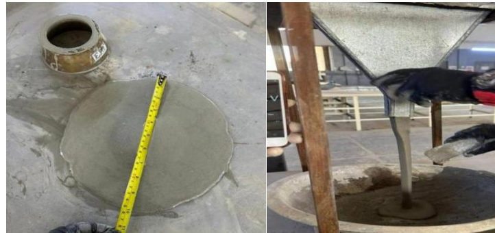
Figure 2. a) Mini slump_flow test. b) Mini_V_funnel test
